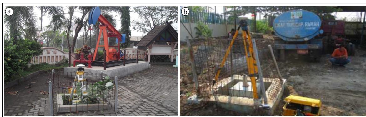
Gambar 8. Pengukuran amblesan tanah dengan menggunakan alat GPS Geodetik di BM-03 (a) dan BM-04 (b).
