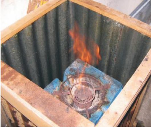
Gambar 8. Tampak kompor pada salah satu rumah warga yang sedang menyala dengan bahan bakar gas alam yang keluar dari retakan tanah di sekitar perkampungan di sekitar lokasi Lumpur Lapindo.
