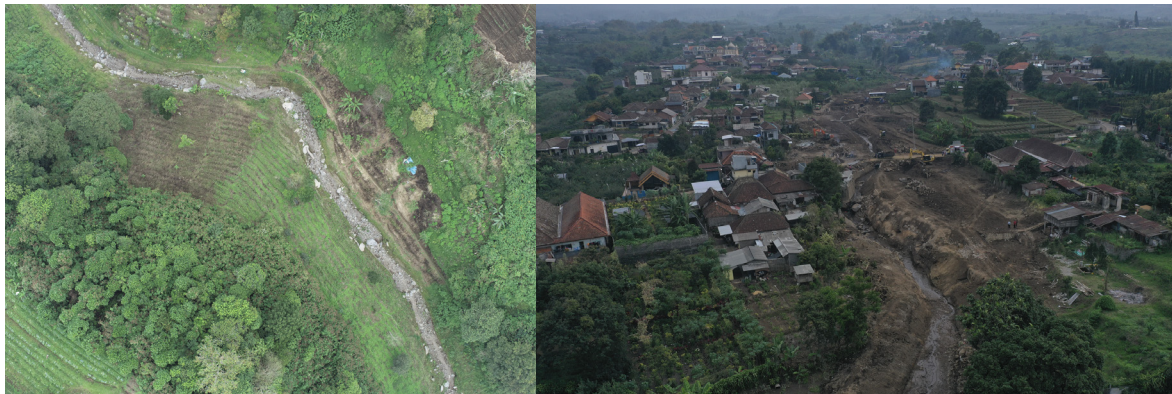
Gambar 5. Perubahan morfologi di bagian hilir yang melandai sebagai zona pengendapan aliran bahan rombakan. Pada lokasi bencana tidak menunjukkan aliran yang overflow membentuk kipas aluvial, namun hanya luapan dari sungai yang tidak mampu menampung debit aliran.
